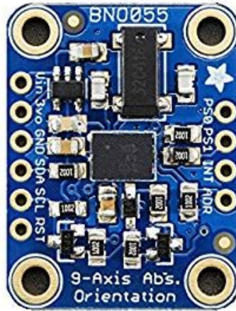
Fig. 1 Bosch Sensortec BNO055 IMU
