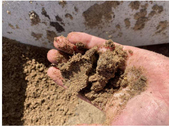
(d) Fine-granular bedding around pipe
