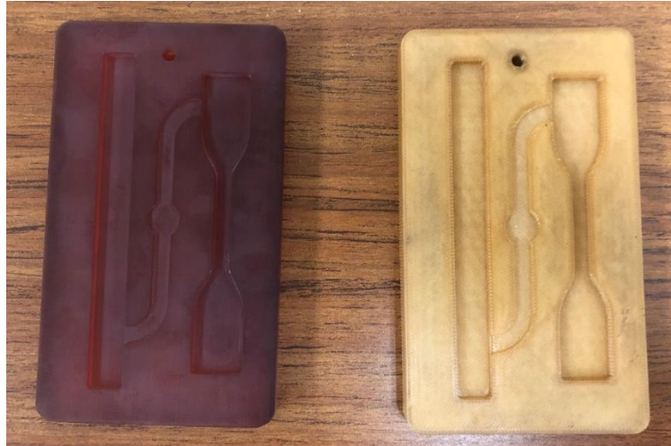
Figure 8: HI-TEMP 300 AMB and ULTEM 1010 mold tool inserts
