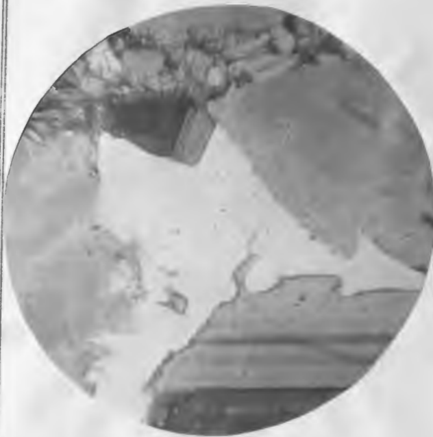
A. Quartz Replacing Plagioclase
