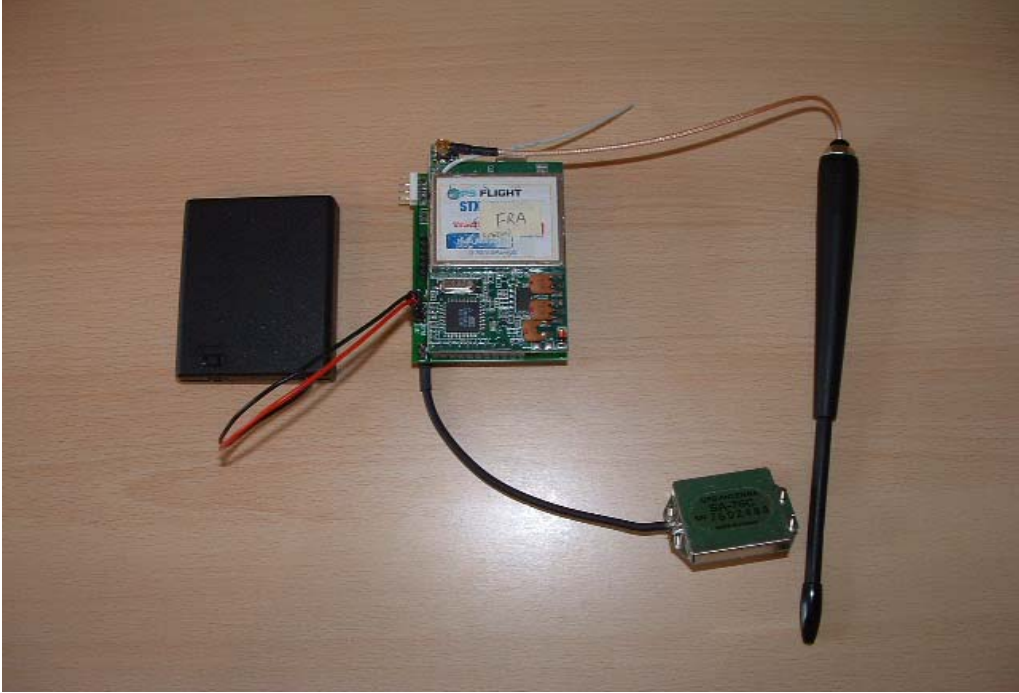
Fig. 2.4 The STXe transmitter module with an antenna.
