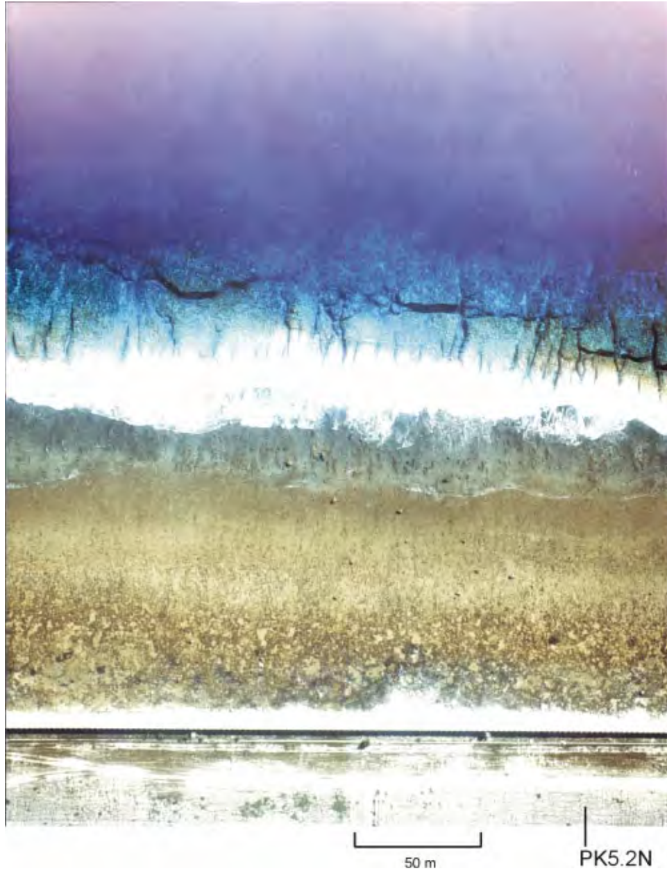
FIG. 2.14 Photographie aérienne montrant des fractures en extension sous-marines, d'une largeur de l'ordre de 2 mètres, au voisinage de PK5N, section Irène (voir aussi Figure 5.6) ; une partie de la piste d'atterrissage, avec son mur protecteur, parallèle au bord du cliché, est visible dans la partie basse de la photographie ; cette région est à l'extérieur de la zone d'essais 1 [photo fournie par le DIRCEN/CEA]
