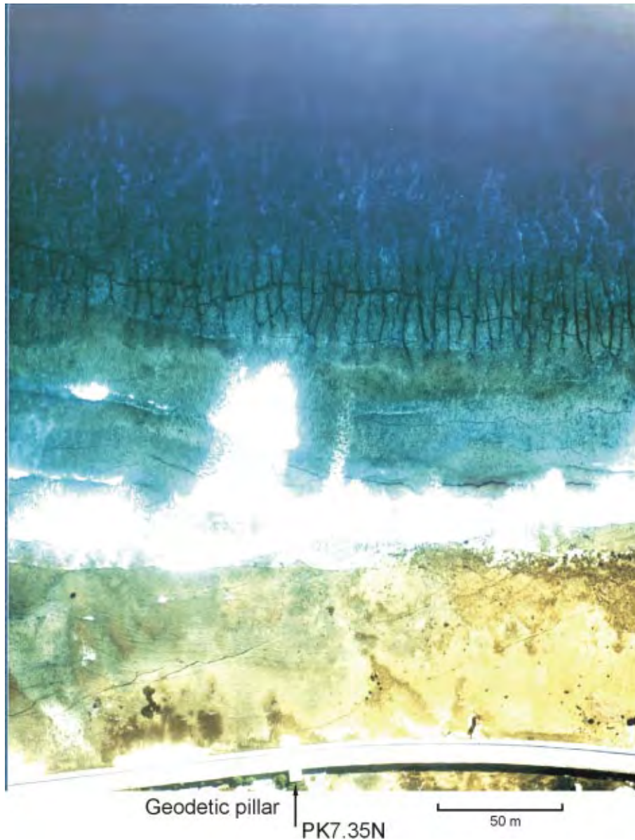
FIG. 2.13 Photographie aérienne montrant les fractures en extension engendrées par la déformation de fluage continue qui a affecté la pente océanique de la couronne nord-est de Mururoa au voisinage de PK7-4N (zone Camélia), dans la zone d'essais 1 (voir la carte de Mururoa en Frontispice ; plusieurs fractures relativement étroites (10 à 20 cm), d'orientation E-N-E, sont visibles sur le rivage ; de plus grandes fractures, dont l'ouverture va probablement jusqu'à 2 mètres, peuvent être discernées sous plus grande profondeur d'eau) [photographie fournie par le DIRCEN/CEA]
