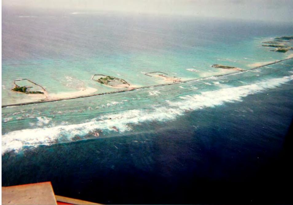
FIG. 2.22 Vue aérienne de la partie ouest de la zone d'essais 4 à Mururoa, prise en juillet 1996 (soit 16 ans après que les essais sur la couronne eurent cessé); la vue est prise de l'océan, en direction du lagon (remarquer que plusieurs sites d'essais et des zones affaissées à l'extrémité ouest de la zone d'essais 4 sont maintenant sous la mer; voir aussi Figure 2.23)
